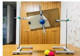
紙を取り付けた板を前後左右に傾け、紙を切る角度を変える。
