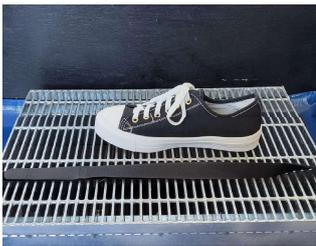
下に滑り止めのシートを置き、その上に群馬県規格のグレーチングを置いた。マジックテープで水準器アプリを開いたスマートフォンを固定し、その脇に靴を設置した。グレーチングの写真右端の方を持ち徐々に傾け、靴が滑って移動した角度を計測する。グレーチングは手動での傾け、また靴の滑りも目視での確認であるため、計測結果に不安が残る。傾け機構の制作方法を模索中である。角度計測には以下のアプリケー
